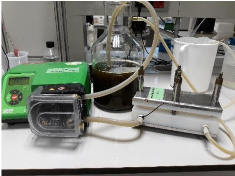
Figura 2. Proceso de ultrafiltración, a 10 kD, del hidrolizado de Codium, y aspecto del concentrado (corriente más oscura y el permeado (corriente más clara).
