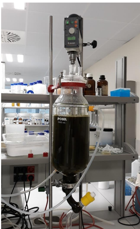
Figura 1. Imagen del proceso de hidrólisis enzimática, llevado a cabo con el alga Codium .
