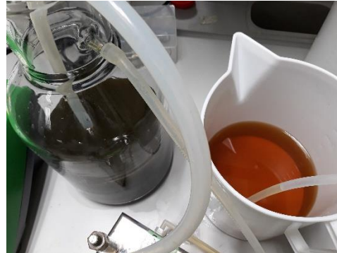
Figura 2. Proceso de ultrafiltración, a 10 kD, del hidrolizado de Codium, y aspecto del concentrado (corriente más oscura y el permeado (corriente más clara).
