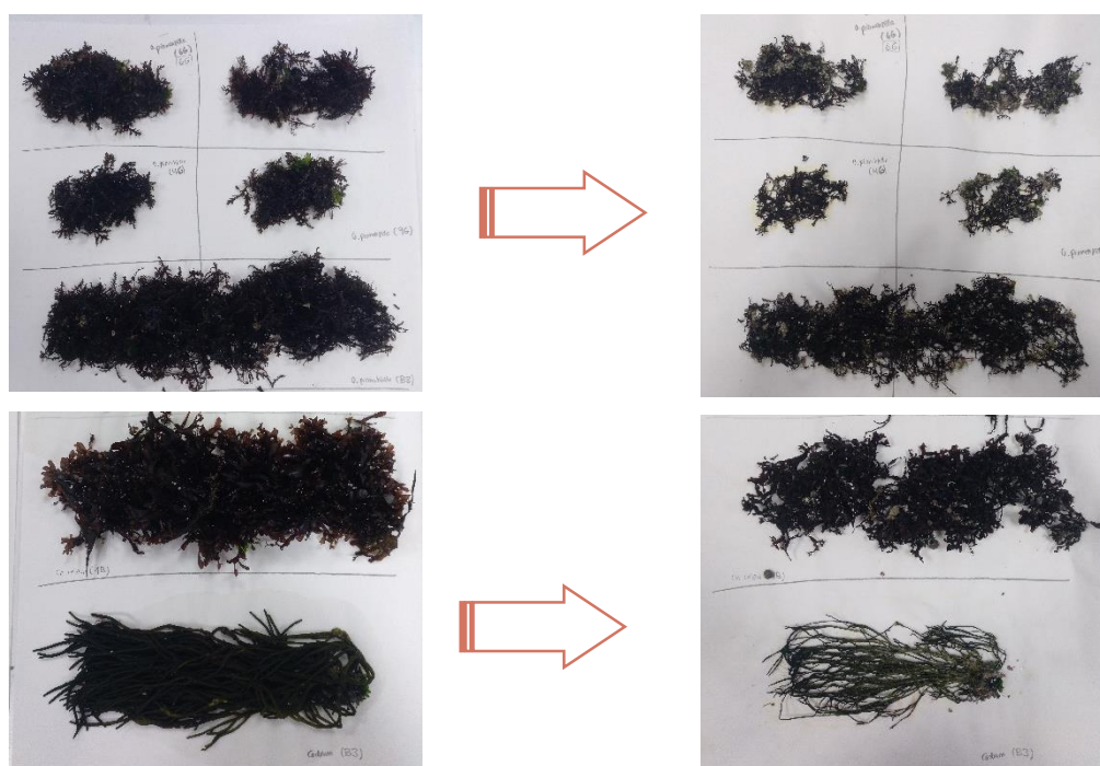
Figura 11. Fotografías del proceso de secado de muestras (estufa 60 °C, 48 h) para la obtención de las relaciones de porcentaje de cobertura (PC), peso fresco (PF) y peso seco (PS) utilizadas en el cálculo de las ecuaciones predictivas.
