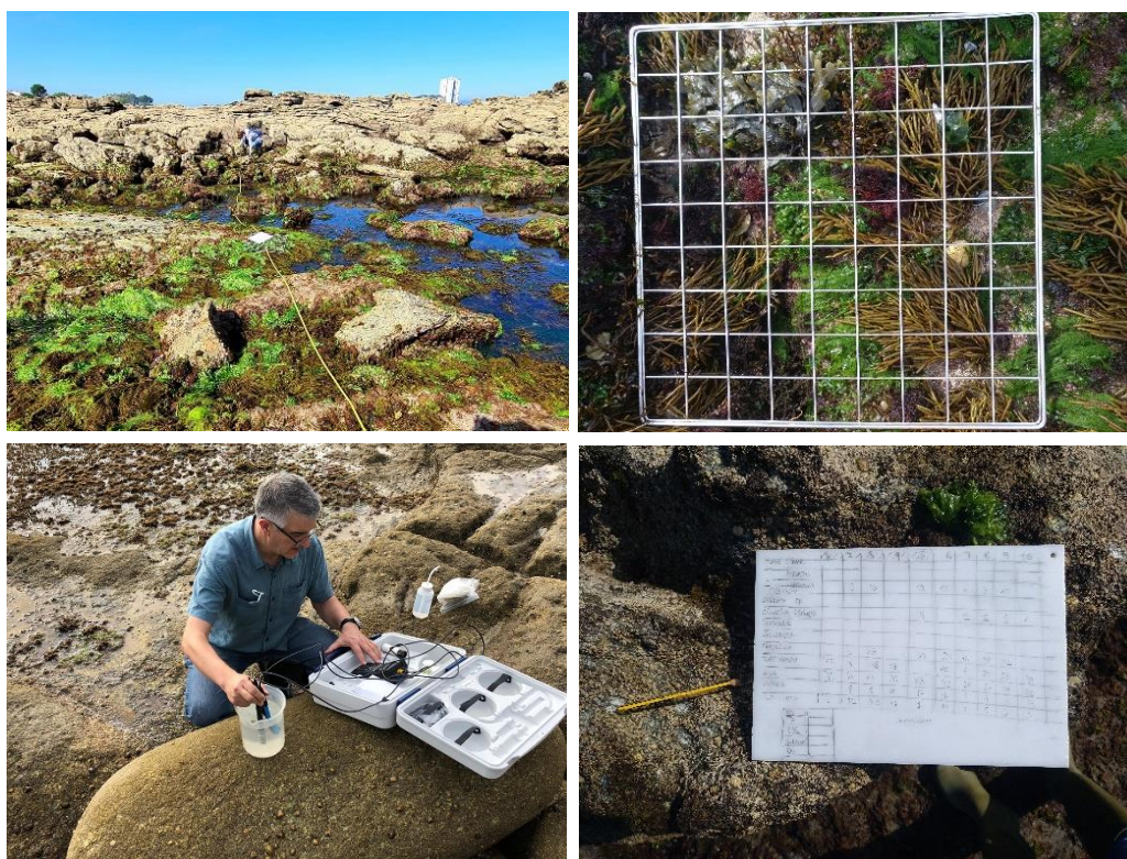
Figura 10. Fotografías tomadas durante las campañas realizadas en la costa de Galicia en las que se muestran diferentes materiales y equipos utilizados en la toma de muestras. De izqda. a dcha. y de arriba abajo: (a) medición de longitud del transecto con cinta métrica, (b) cuadrante definido como unidad de muestreo, (c) medición de los parámetros físico-químicos del agua de mar superficial, (d) tablilla donde se recogieron los datos obtenidos en el campo.
